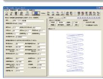
圧縮ばね、引張りばね、ねじりコ イルばねの計算、作図を行います。 ばねを設計する際に必要な情報 を入力することにより、設計者が 求める理想的なばね計算を行うこ とが出来ます。ばねを作図する 前にイメージ図を表示しますので 形状の確認が出来ます。
